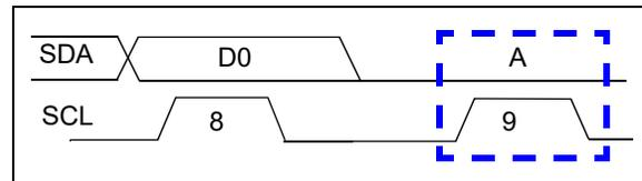
FIGURE B-4: ACKNOWLEDGE WAVEFORM.
