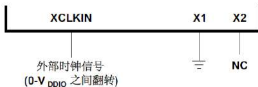
图8-1 XCLKIN接3.3V晶振时钟
