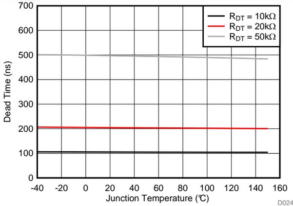
图 23. Dead Time Temperature Drift
